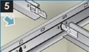
Para colocar un segundo secundario se procede de igual manera que con el primero, utilizando la misma lumbrera del primario por el lado que permanece libre. Un leve empujón hasta escuchar un “clic” será suficiente para que quede automáticamente conectado.
