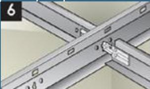
La seguridad, la resistencia a las presiones laterales y la dimensión del módulo quedan perfectamente garantizadas una vez que se han colocado los secundarios, que quedan cerrados entre sí ofreciendo una total resistencia.
