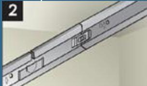
El desmontaje de los elementos primarios es rápido y sencillo, no hay que utilizar herramienta alguna y permite su reutilización ya que no sufren ningún deterioro en este proceso. Para realizar esta desconexión basta con tirar y empujar cada una de las piezas en un plano horizontal.
