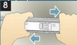
Es importante no doblar la perfilería durante el montaje. Para desconectar los elementos primarios hay que empujar hacia el fondo con la mano izquierda y tirar hacia uno mismo con la derecha.
