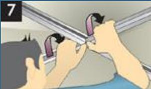
La desconexión no necesita la utilización de ninguna herramienta y permite la reutilización de los elementos ya que no sufren ningún deterioro. Para desarmar el secundario hay que sujetar el primario con ambas manos y dejar el secundario en medio, los pulgares se colocan debajo de la conexión principal; para desmontar elementos hay que presionar hacia arriba y realizar un leve giro del primario hacia fuera.
