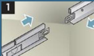
De forma sencilla y sin necesidad de herramientas, la unión de los elementos primarios se realiza sin esfuerzo con la precisa conexión de los cierres situados en los extremos.
